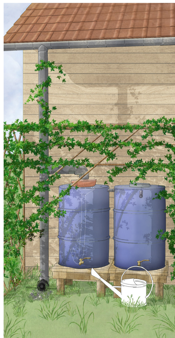
Sistema di raccolta delle acque dal tetto con separazione delle acque luride.
