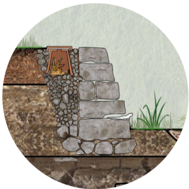
Muro in pietre a secco e cavità
